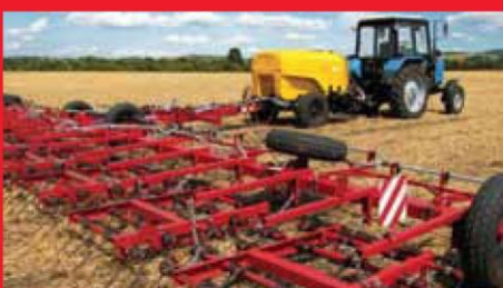
REÁL Fogasborona folyékony műtrágyakijuttatásra alkalmas adaptációval
